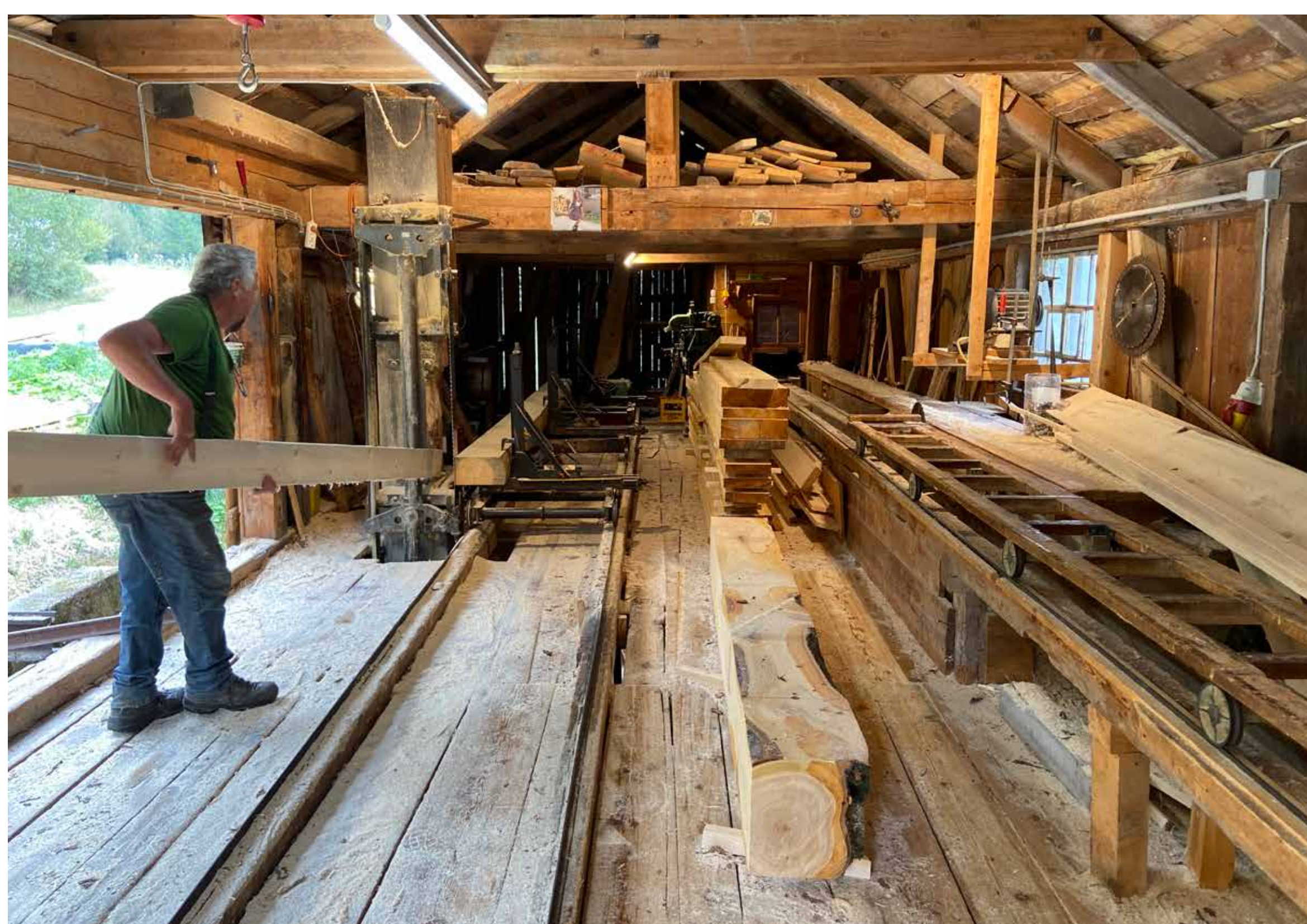
Fertig geschnittenes Brett wird vom Gatter entnommen und zur Besäumfräse gebracht.
