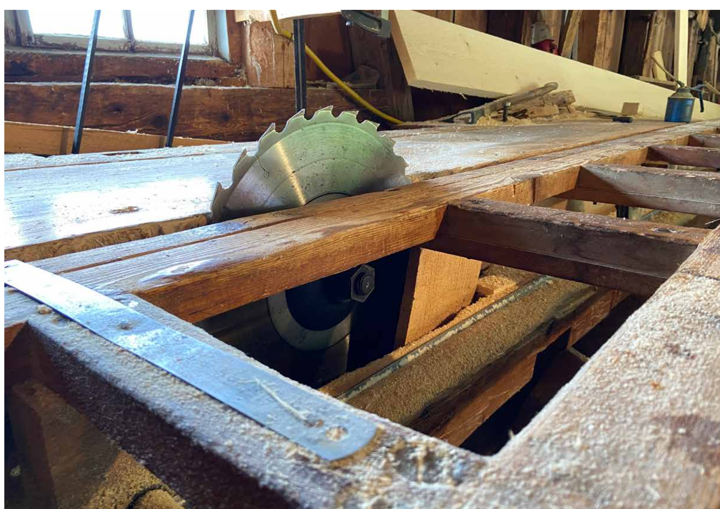
Hier wird beidseitig die Kante vom Brett auf der Wagenfräse besäumt.
