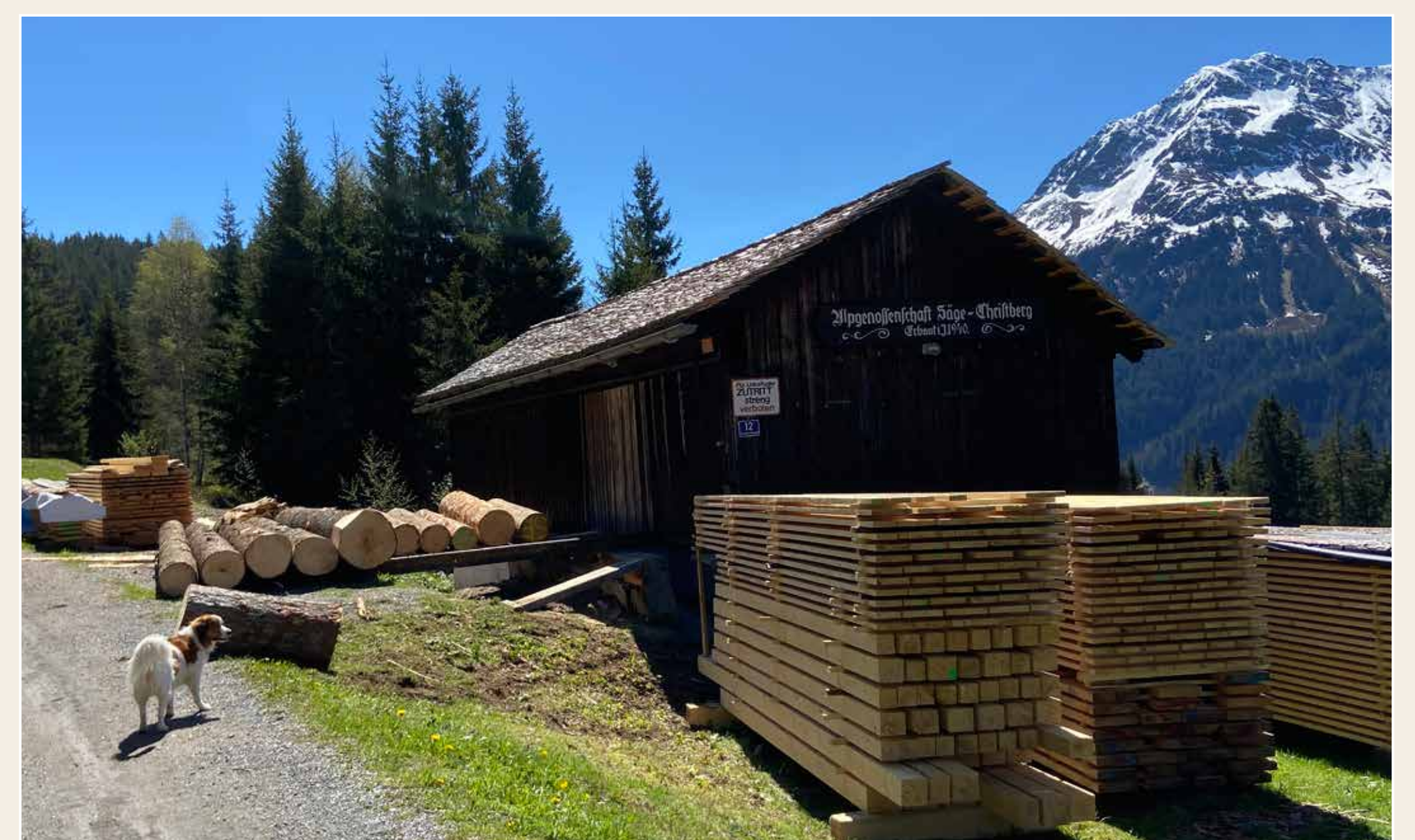
Das fertige Produkt (Balken, Bretter, ...) wird zum Trocknen aufgeschichtet.
